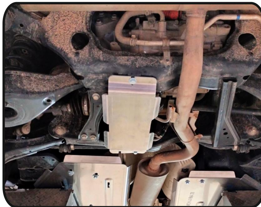
**Защита заднего редуктора (алюминий) 4 мм
