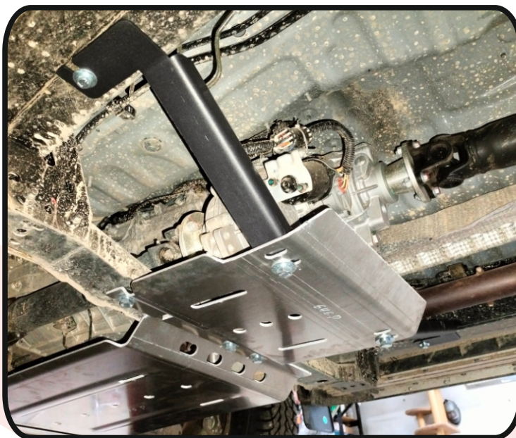
Защита раздаточной коробки (алюминий) 4 мм арт. ZKTCC00646.
