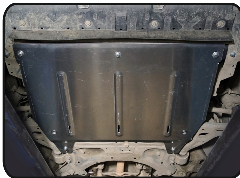
Защита картера и КПП (алюминий) 4 мм арт.ZKTCC00626.
