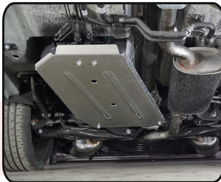
**Защита бака и заднего редуктора (алюминий) 4 мм
