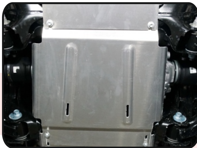
Защита переднего редуктора (алюминий) 4 мм арт. ZKTCC00503.
