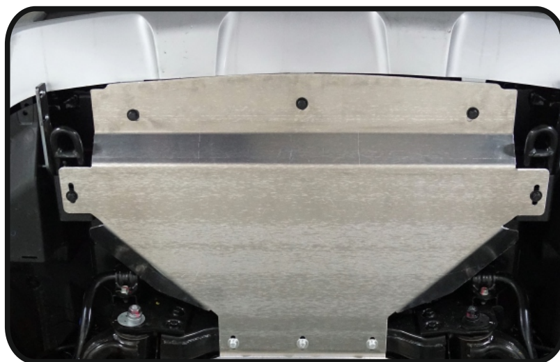
Защита радиатора (алюминий) 4 мм арт.ZKTCC00462.
