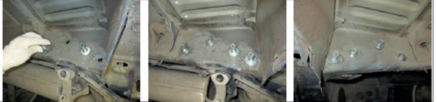
**ШАГ 3.** Установите балку ТСУ, совместив НИЖНИЕ отверстия в закладных и в балке ТСУ. Соедините их с помощью болтов М12х1,25х40 через шайбы 12 гроверные и шайбы 12 увеличенные, гайками М12х1,25. Затяните все соединения.
