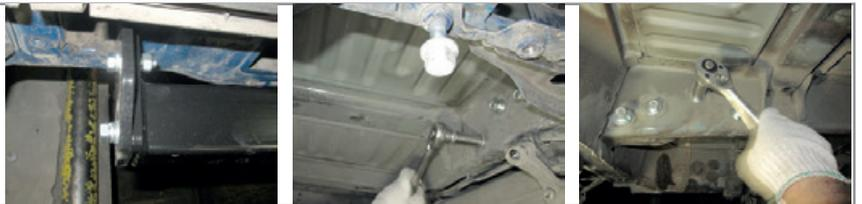
**ШАГ 4.** С помощью хомутов из комплекта поставки прикрепите проводку парктроников к кузову автомобиля и к отверстиям в закладных пластинах, как показано на фото. Обрежьте усики хомутов с помощью ножа или кусачек.
