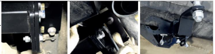
ШАГ 6. Установите фиксирующий болт M10x20 снизу, он используется для исключения технологических люфтов съемного шара и только в ненагруженном состоянии! Перед сцепкой болт демонтировать!
