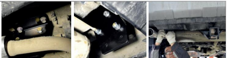
ШАГ 5. Установите балку ТСУ, прикрепив его болтами M10x1,25x40 через шайбы и шайбы 10 гроверные гайками M10x1,25. Затяните все резьбовые соединения. Установите кронштейн розетки, закрепив его гайкой M10 через шайбу 10 увелич. и гровер 10. Установите шар в сборе и зафиксируйте его пальцем со шплинтом.
