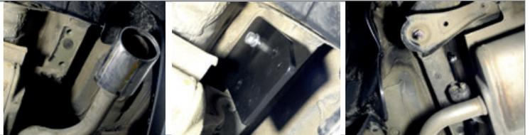
ШАГ 4. Установите уголок на правой стороне, совместив отверстия уголка, кронштейна и лонжерона автомобиля. Соедините уголок с кронштейном болтами M12x1,25x40 через шайбы 12 с двух сторон, шайбы 12 гроверные и гайки M12. А так же соедините с лонжероном штатными болтами крепления проушины.
