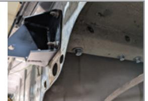
**ШАГ 4.** Установите центральную балку, закрепив её болтами M10 x 30 x 1,25 через шайбы 10 и гроверные шайбы 10. Затяните все соединения! Поставьте задний бампер на место, предварительно вырезав в нём отверстие по прилагаемому шаблону.
