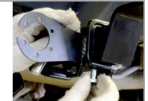
**ШАГ 6.** Установите съёмный шар в сборе и закрепите его пальцем гнутым гальванизированным со шплинтом пружинным игольчатым. Затяните фиксирующий болт M10x20 снизу, он используется для исключения технологических люфтов съёмного шара и только в ненагруженном состоянии! Перед сцепкой болт демонтировать! Установка завершена.
