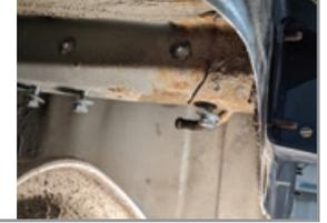
**ШАГ 3.** Установите правый кронштейн крепления аналогичным способом. Закрепите кронштейны на штатных шпильках штатными гайками с фланцем.
