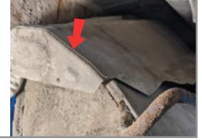
**ШАГ 2.** Установите левый кронштейн крепления, поместив его в отверстие в лонжероне, и совместив штатные шпильки с отверстиями кронштейна. Закрепите кронштейн в лонжероне болтами M10 x 30 x 1,25 через шайбы увеличенные 10 и шайбы гроверные. Соединения не затягивать.
