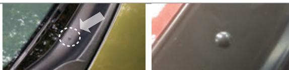
Перед началом эксплуатации накладки необходимо убедиться, что накладка не задевает кромку капота, для этого закройте полностью капот. Убедитесь в присутствии равномерного зазора не менее 4-5 мм вдоль всей кромки капота, в противном случае отрегулируйте крепление крышки капота добившись необходимого зазора!
