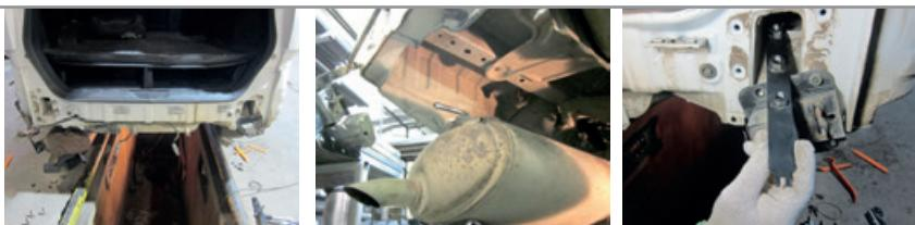
**ШАГ 2.** Установите кронштейн правый, совместив отверстия кронштейна с отверстиями в лонжероне автомобиля и соедините их с закладными пластинами с помощью болтов M12x1,25x40 через шайбы 12 и шайбы 12 гроверные.
