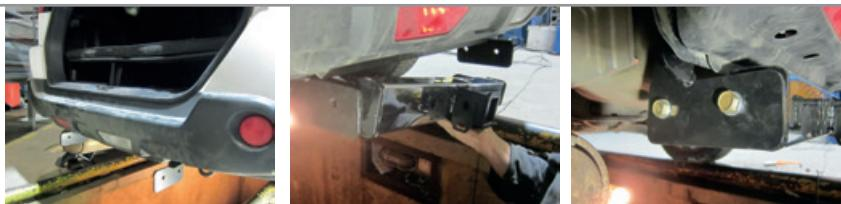
**ШАГ 5.** Затяните все соединения, отрегулировав положение ТСУ. Установите съёмный шар в сборе и закрепите его пальцем гнутым гальванизированным со шплитом пружинным игольчатым. Затяните шар ключом на 38 мм.
