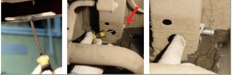
**ШАГ 2.** Установите боковые кронштейны и закрепите их к закладным пластинам с помощью гаек М12х1,25 через шайбы 12 и шайбы 12 гроверные. В передней части автомобиля кронштейн крепится к штатным закладным гайкам М12х1,25 в лонжероне. С помощью болтов М12х1,25х45 с юбкой, через шайбы 12. Кронштейны не затягивайте.
