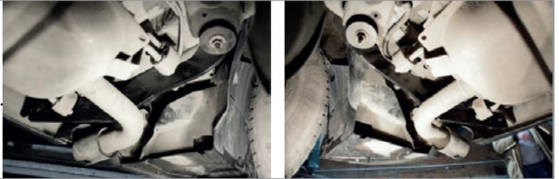
**ШАГ 3.** Установите балку ТСУ, совместив отверстия в балке ТСУ с отверстиями в боковых кронштейнах и соедините всё с помощью болтов М10х1,25х40, гайк М10х1,25, шайб 10 и шайб 10 гроверных.
