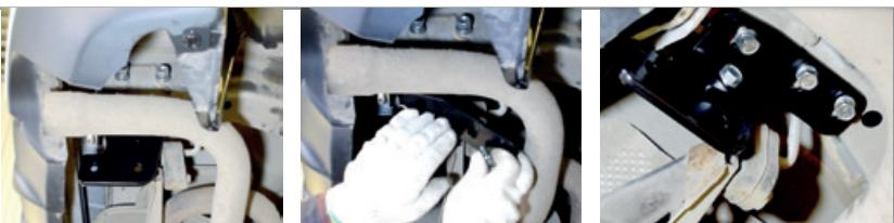
**ШАГ 4.** Для установки балки ТСУ совместите отверстия в кронштейне с резьбовыми отверстиями боковых кронштейнов и соедините помошью болтов M10x1,25x30, через шайбы 10. Затяните все резьбовые соединения.
