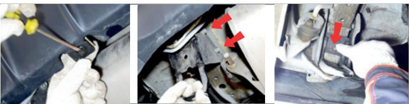
**ШАГ 2.** Установите кронштейн (поз. Q) и прикрутите его с помощью болтов M12x1,25x110 продетых сквозь лонжерон, гайками M12x1,25 через шайбы 12 и шайбы 12 гроверные. Кронштейн устанавливается с внутренней стороны лонжерона гибом в центр автомобиля.
