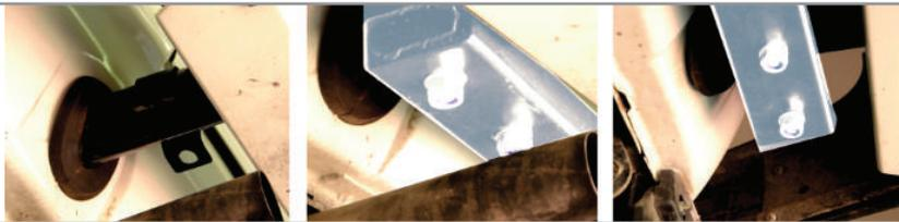
**ШАГ 2.** Для установки центрального кронштейна совместите отверстия кронштейна с отверстиями в ушках поперечной балки и соедините болтами M12x1,25x45 через шайбы 12 и самоконтрящиеся гайки M12x1,25.
