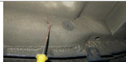
**ШАГ 3.** Для установки фаркопа совместите отверстия в балке ТСУ с резьбовыми отверстиями кузова автомобиля и соедините всё с помощью болтов М10, через шайбы 10 увеличенные и шайбы 10 гроверные.
