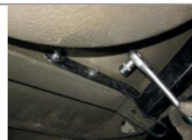
**ШАГ 5.** Установите съёмный крюк и закрепите его вместе с кронштейном розетки болтами М12х1,25х80 и гайками М12х1,25, через шайбы 12 с двух сторон и гроверные шайбы. Выровняйте фаркоп и затяните все соединения. Установка завершена.
