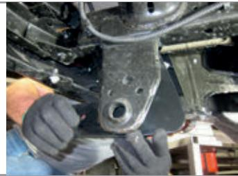
**ШАГ 3.** Закрепите закладную пластину на боксирной проушине с помощью двух болтов M10x1,25x40 через шайбы и шайбы 10 гроверные, как показано на фото.
