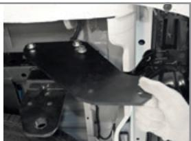
**ШАГ 2.** Установите балку ТСУ, совместив отверстия балки ТСУ с отверстиями боковых кронштейнов. Соедините всё с помощью болтов M12x1,25x40 через шайбы 12 с двух сторон и шайбы 12 гроверные, гайками M12x1,25. Соединения не затягивайте.
