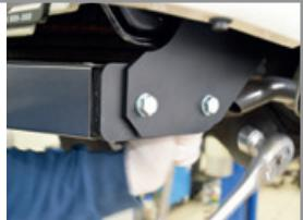
**ШАГ 3.** Отрегулируйте положение балки ТСУ относительно бампера автомобиля, обеспечив минимальный зазор 10 мм. Затяните все резьбовые соединения начиная с боковых кронштейнов. Установите съемный шар в сборе и закрепите его пальцем гнутым.
