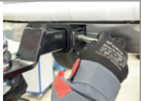
**ШАГ 4.** Зафиксируйте палец гнутый с помощью шплинта игольчатого.
