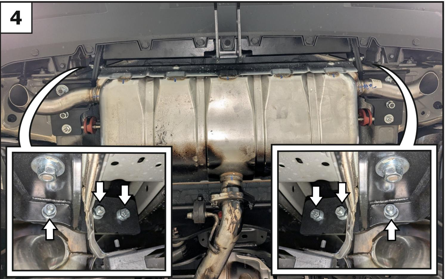
Прогнать резьбовые отверстия балки (1) с помощью метчика М12х1,25. Установить балку (1), закрепив её к кронштейнам с помощью болтов М12х1,25х40 (8), гаек М12х1,25 (12), шайб 12 пружинных (15) и шайб 12 (16).
