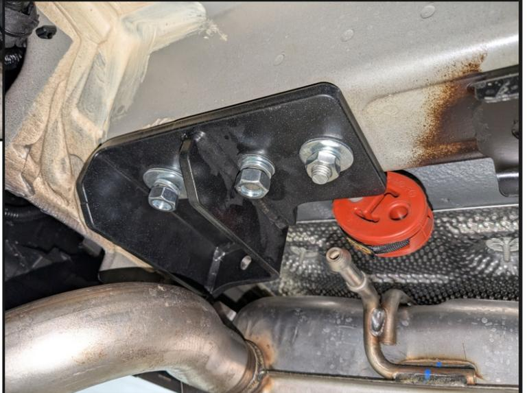
Установить левый и правый кронштейны (2 и 3), закрепив их к закладным шпилькам М10 (4) и штатным шпилькам с помощью гаек М10 (10), шайб 10 пруж. (13), шайб 10 увел. (14), гайк М12 (11), шайб 12 пруж. (15), шайб 12 (16), шайб 12 увел. (17).
