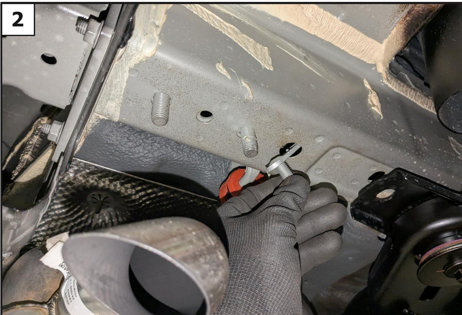
**Установить шпильки закладные М10 (4) в лонжероны автомобиля.**
