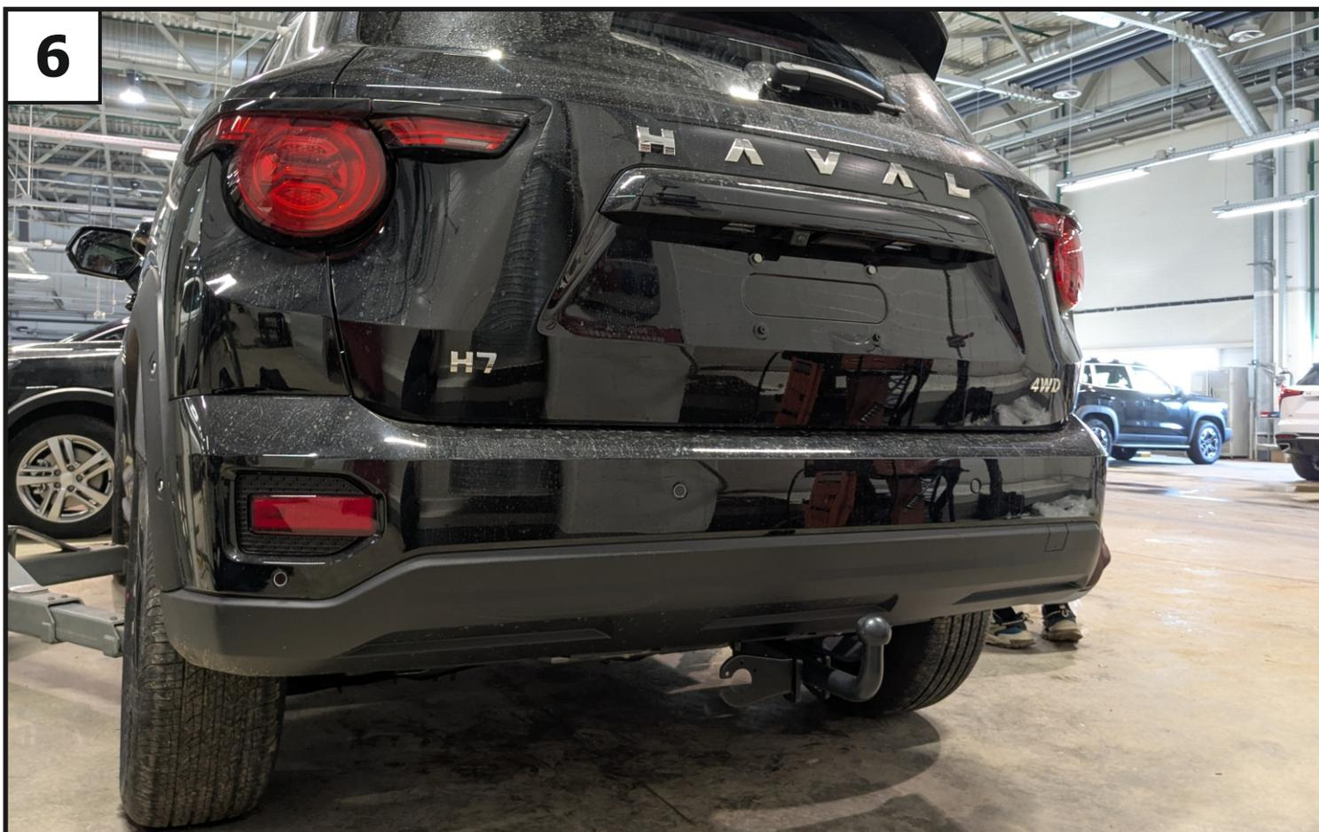
Установить кронштейн под розетку (5) и крюк (6), закрепив их с помощью болтов  $M_{12} \times 1,25 \times 90$  (9), гаек  $M_{12} \times 1,25$  (12), шайб 12 пружинных (15) и шайб 12 (16). Затянуть резьбовые соединения. Момент затяжки:  $M_{12}=81$  Нм.
