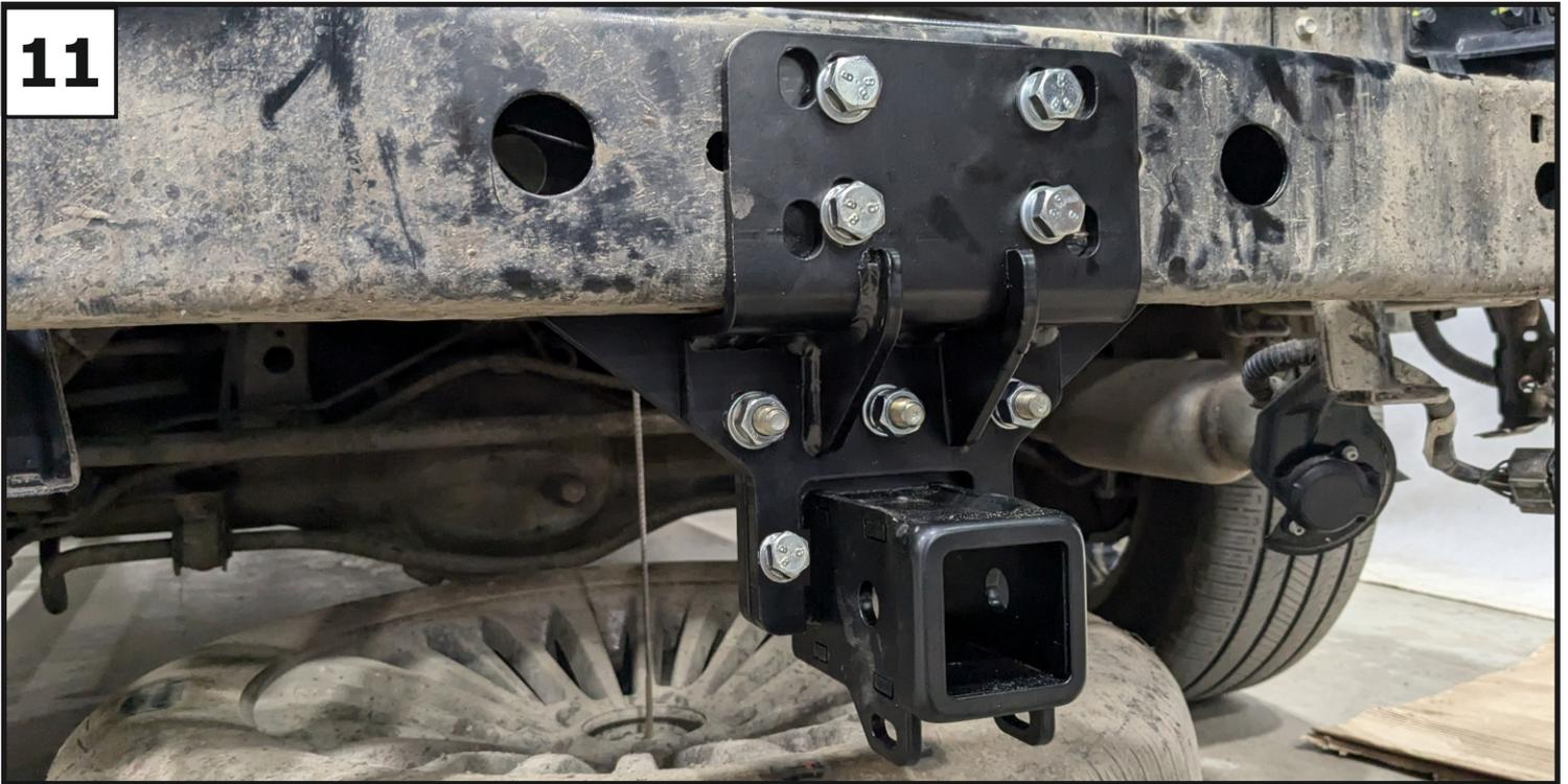
**Затяжку производить в строгой последовательности: затянуть между собой кронштейн (1) и усиление (2) болтами М12х1,25х50 (11) и болтами М10х1,25х40 (9), затем затянуть кронштейн(1) к поперечине гайками М12х1,25 (14), затем - усиление (2) к поперечине болтами М14х1,5х40 (12) (или М12х1,25х40 (10) в зависимости от даты производства автомобиля).**
