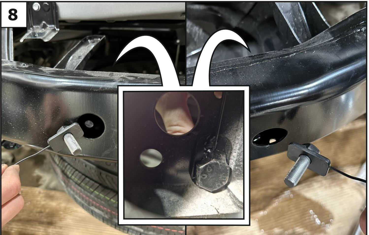
Установить закладные М12х1,25 (3) в поперечину рамы, обеспечив выход резьбы со стороны запасного колеса.
