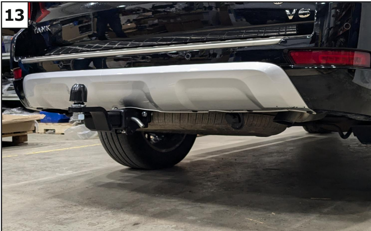
**Установить переходник (4), закрепив с помощью штифта (6) и шплинта (7).
