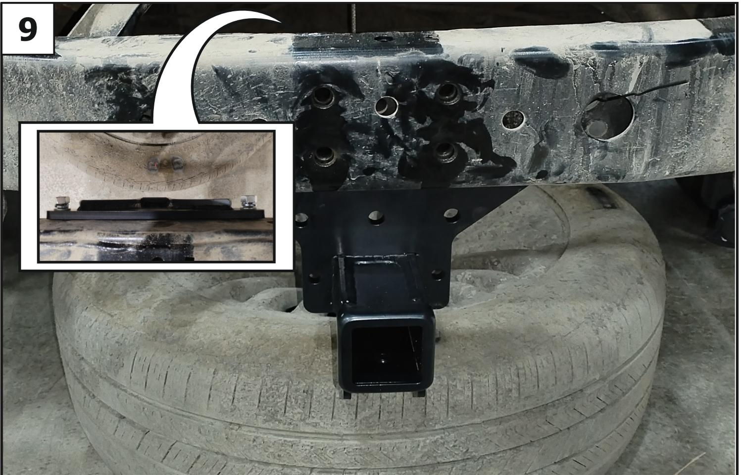
С обратной стороны поперечины установить кронштейн (1), закрепив его к закладным с помощью гаек М12х1,25 (14), шайб 12 пружин. (18) и шайб 12 (17).
