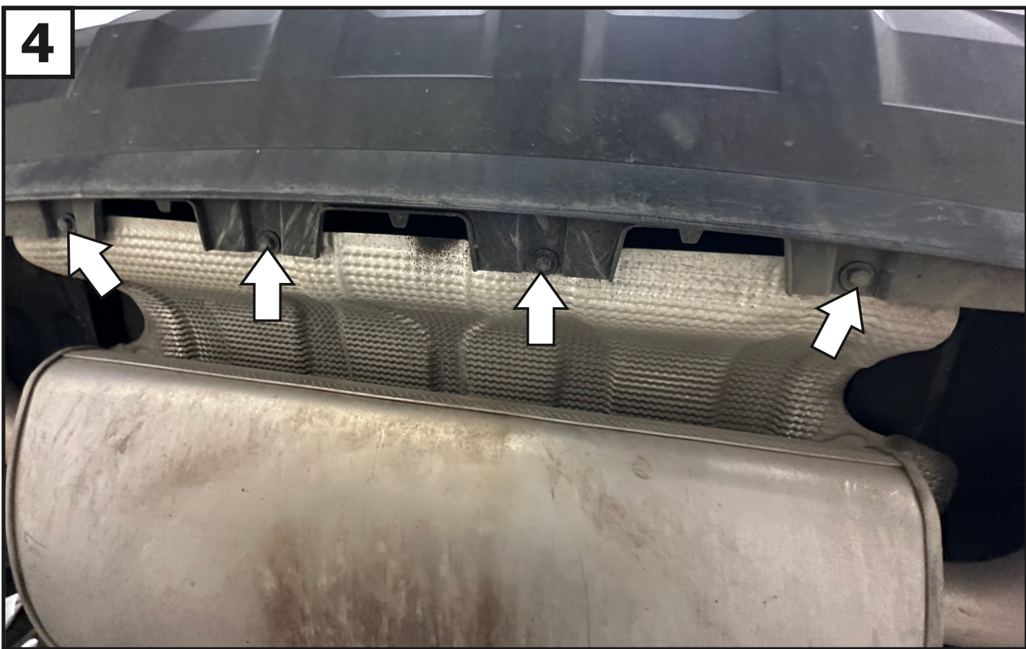
Открутить нижние болты крепления бампера.
