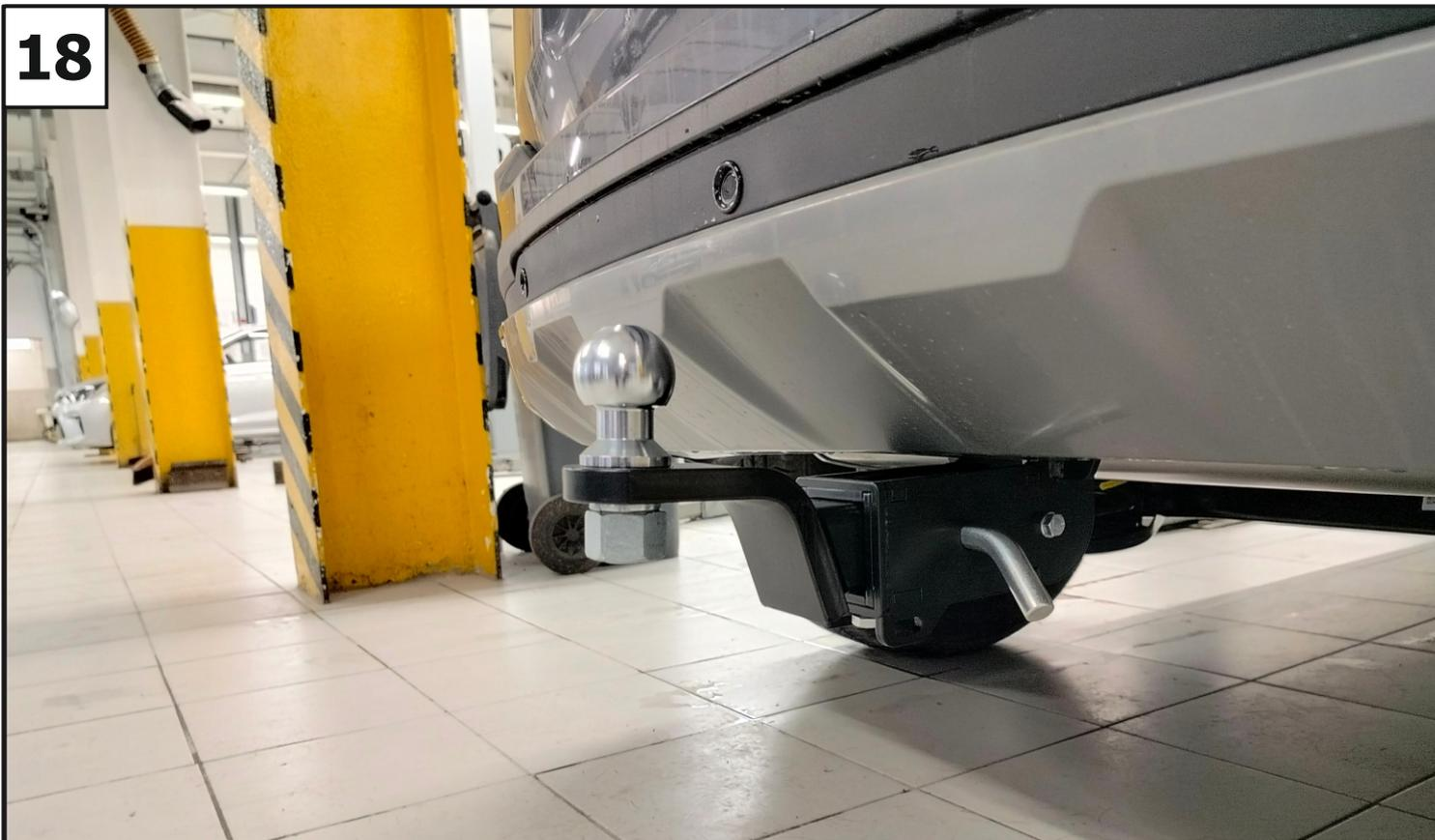
**Установить переходник (4), закрепив с помощью штифта (6) и шплинта (7). Зафиксировать переходник болтом M10x20 (12) - фиксацию использовать без нагрузки. Установить на переходник шар (5), закрепив гайкой M24 (23) с шайбой 24 пружинной (24). Момент затяжки: M24=95 Нм**
