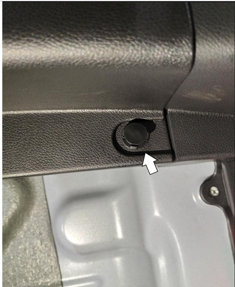
**Демонтировать клипсы крепления обшивки багажника.**
