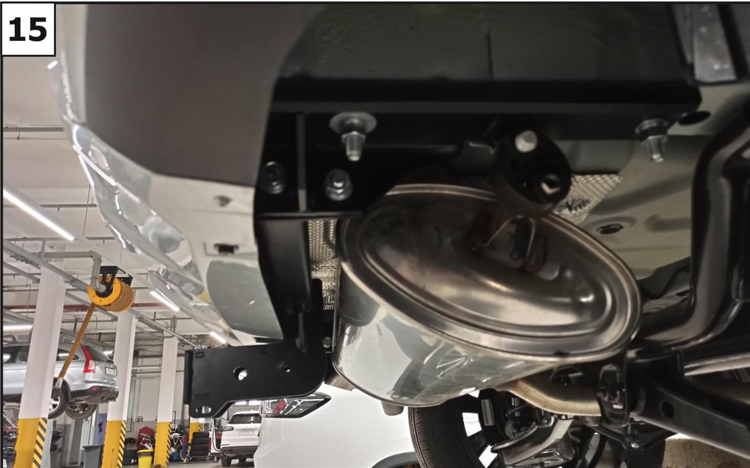
К установленным кронштейнам закрепить балку (1) с помощью болтов М12х1,25х35 (9), шайб 12 (16), шайб 12 пружинных (17) и гаек М12х1,25 (13).
