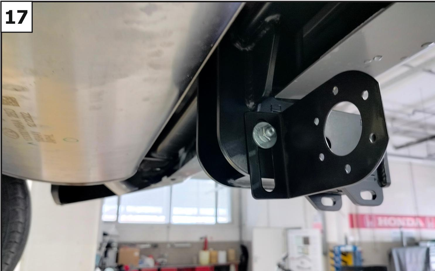
**Установить кронштейн под розетку (8) с помощью болта M8x80 (11), шайбы 8 (19), шайбы 8 увел. (20), шайбы 8 пружинной (21) и гайки M8 (15). Момент затяжки M8=25 Нм.**
