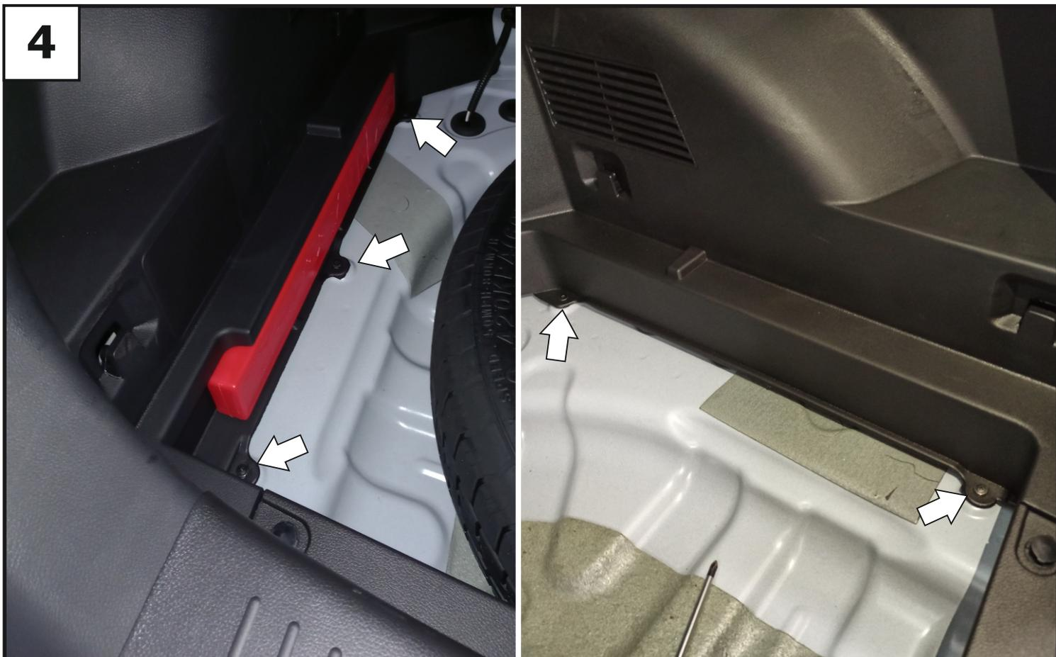
Выкрутить винты крепления обшивки багажника.
