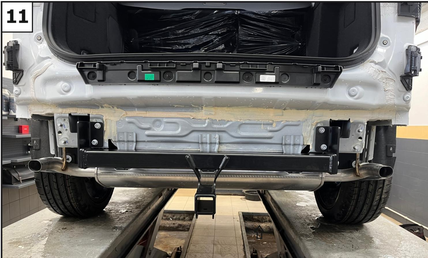
Отрегулировать положение ТСУ относительно центра автомобиля и затянуть все резьбовые соединения — сначала балку с кронштейнами и усиления, затем усиления кронштейна к задней панели автомобиля, в последнюю очередь кронштейны с лонжеронами автомобиля. Моменты затяжки: M10=47 Нм, M12=81 Нм.
