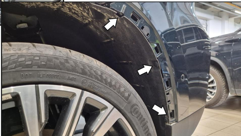
**Демонтировать боковую накладку, после чего выкрутить винт и демонтировать клипсы крепления бампера. С другой стороны аналогично.**
