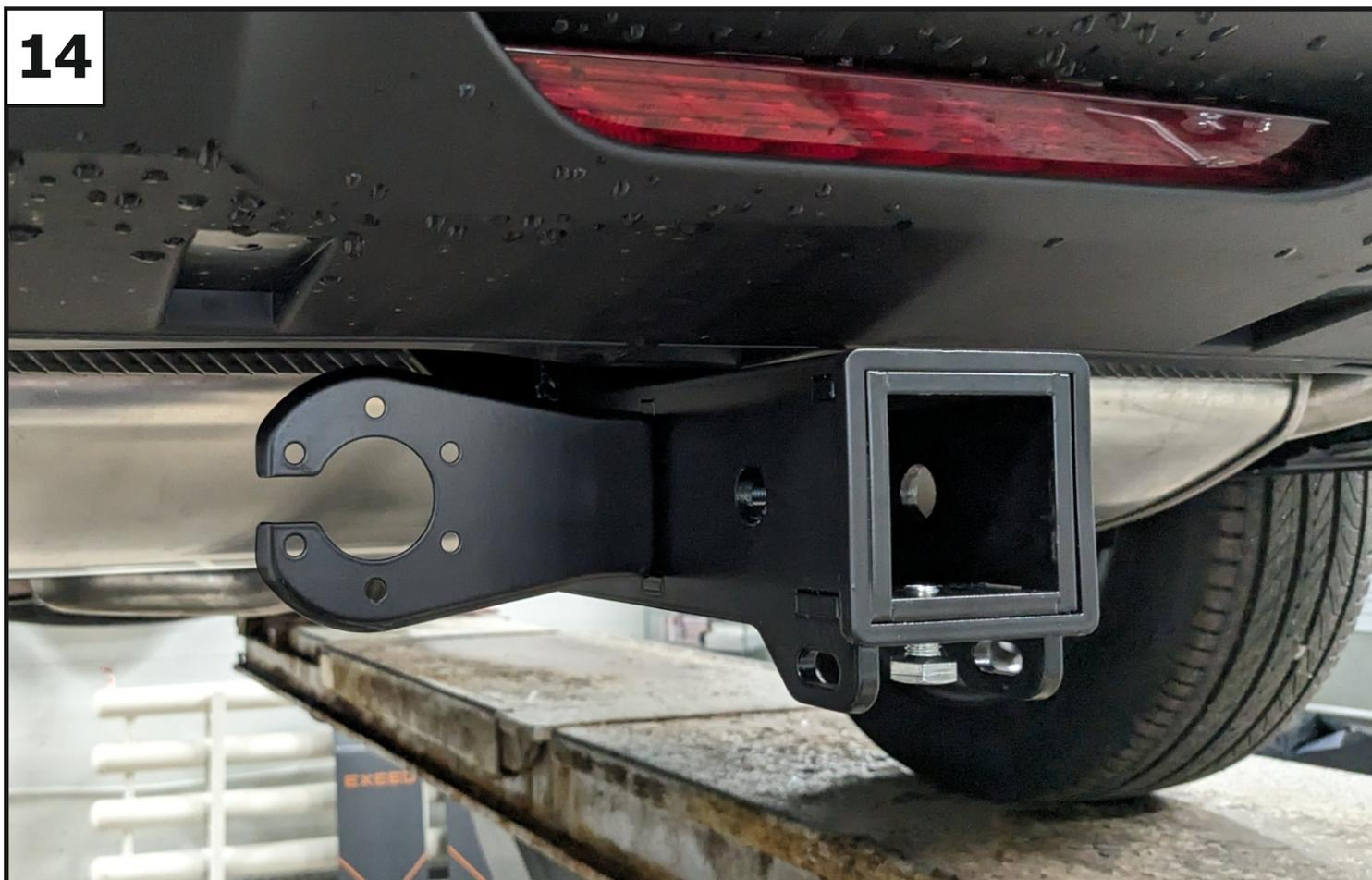
Установить кронштейн под розетку (10) на балку (1) с помощью болта М8х80 (14), шайбы 8 (20), шайбы 8 пружинной (21), шайбы 8 увел. (22) и гайки М8 (17).
