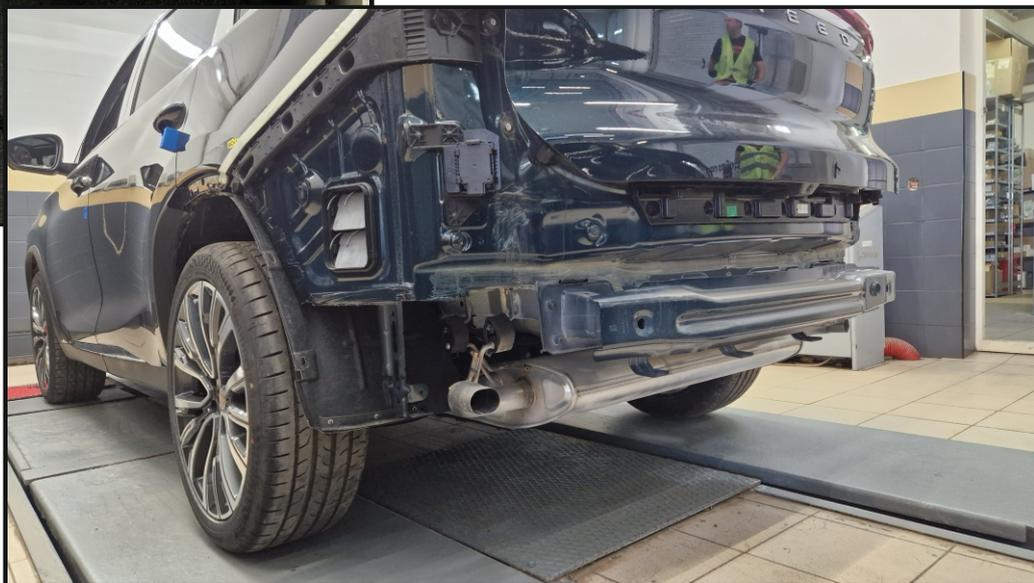
**Отключить разъем электропроводки через технологическое окошко внутри багажного отделения и снять задний бампер.**
