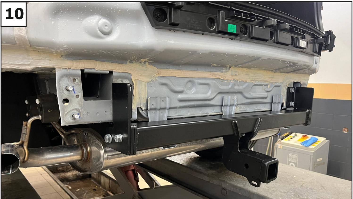
Установить балку (1) закрепив её к кронштейнам (2, 3) и усилениям кронштейна (4, 5) при помощи болтов М12х1,25х40 (16), шайб 12 (25), шайб пружинных 12 (26) и гаек М12х1,25 (19).
