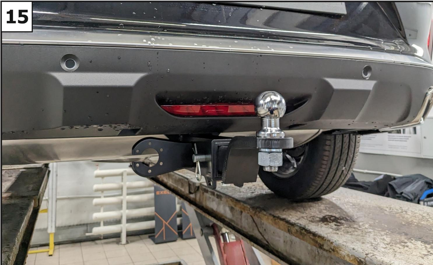
Установить переходник (6), закрепив с помощью штифта (8) и шплинта (9). Зафиксировать переходник болтом М10х20 (15) - фиксацию использовать только без нагрузки. Установить на переходник шар (7), закрепив гайкой М24 (28) с шайбой 24 пружинной (29).
