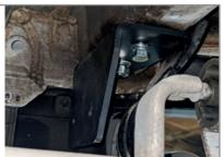
**ШАГ 4.** Установите балку ТСУ на кронштейнах с помощью болтов М10х1,25х40 и гайки М10х1,25, через шайбы 10 и гроверные шайбы 10. Отрегулируйте положение ТСУ и затяните все соединения.
