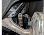
**ШАГ 2.** Поместите закладную пластину внутрь лонжерона, совместив шпильку и приварную гайку с соответствующими отверстиями в лонжероне.
