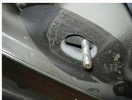
Рис.6 Установка шпильки закладной
