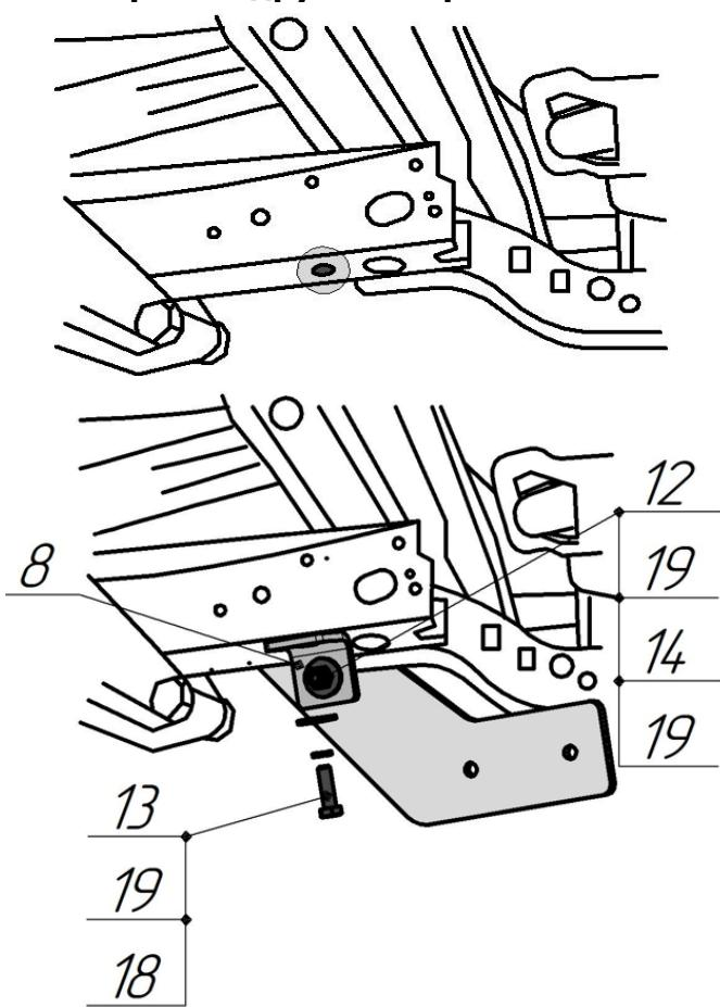
**3** Установить балку (1) и закрепите к кронштейнам (2) с помощью крепежных изделий (12,14,17) и (12,17,18) с двух сторон.
