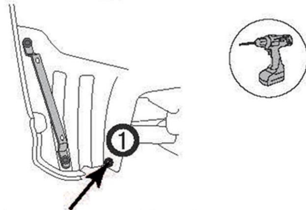
Снять брызговик, в отмеченной точке 1 используя сверло Ø 8 мм просверлите отверстие в подкрылке.
